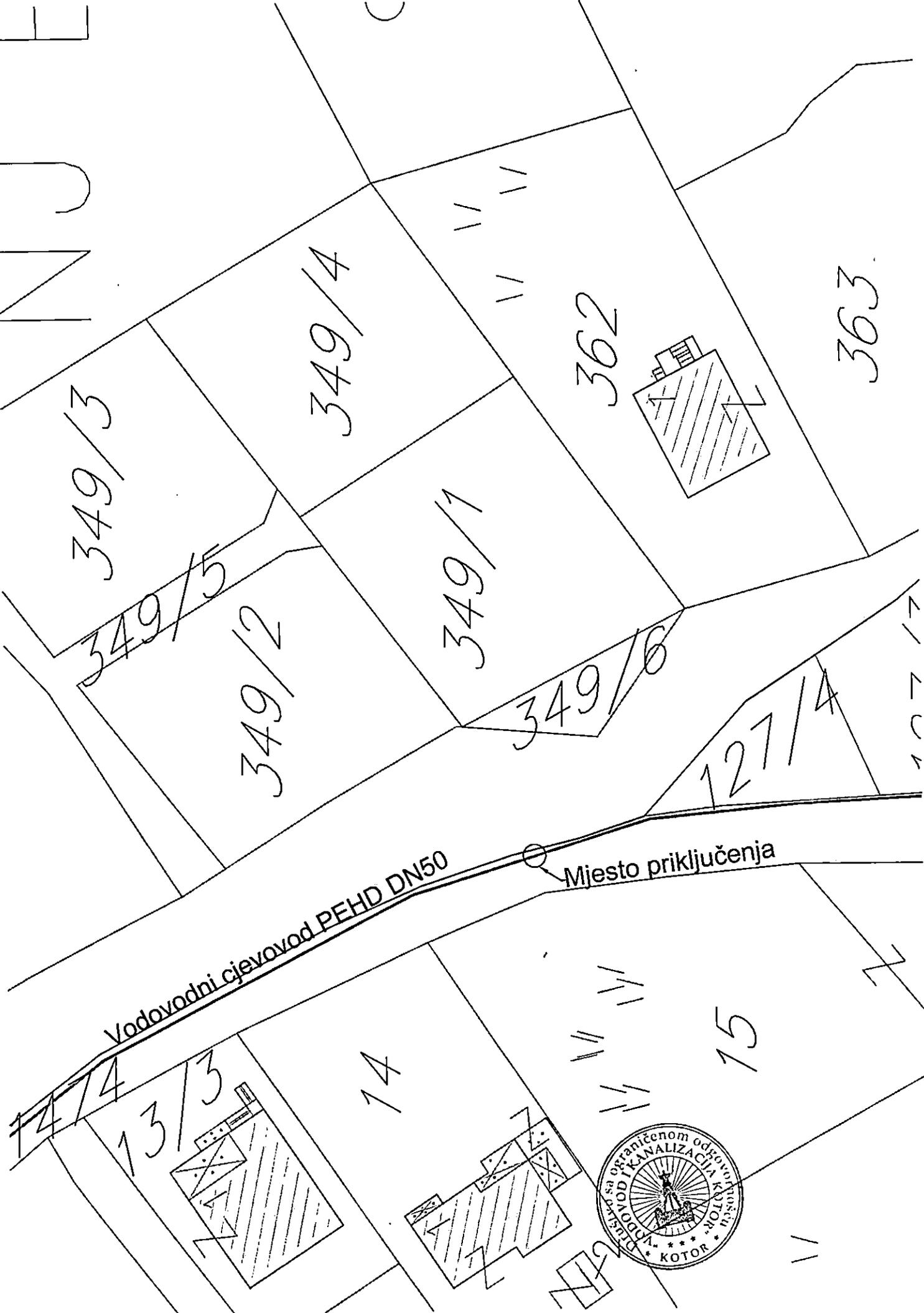
Vodovodni cjevovod PEHD DN50
