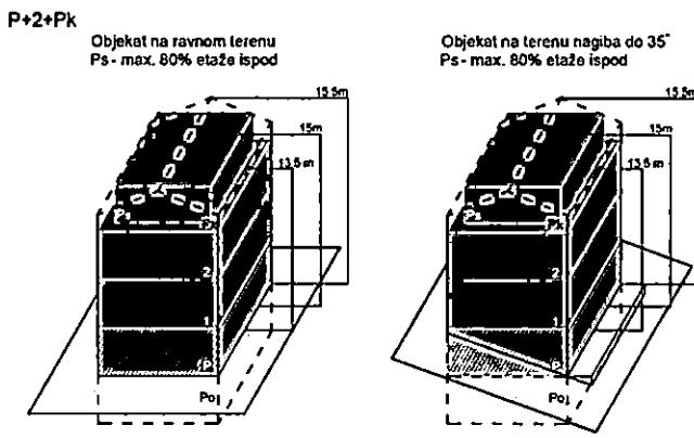
Najveća visina etaže za obračun visine građevine, mjerjenja između gornjih kota međuetažnih konstrukcija iznosi:
