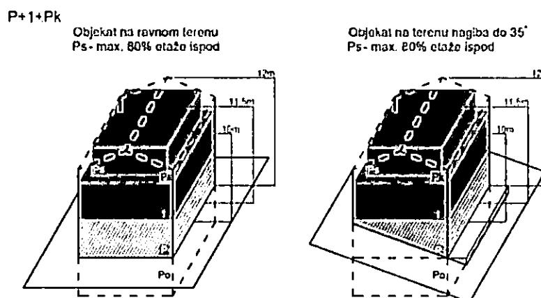
Najveća visina etaže za obračun visine građevine, mjerena između gornjih kota međuetažnih konstrukcija iznosi:
