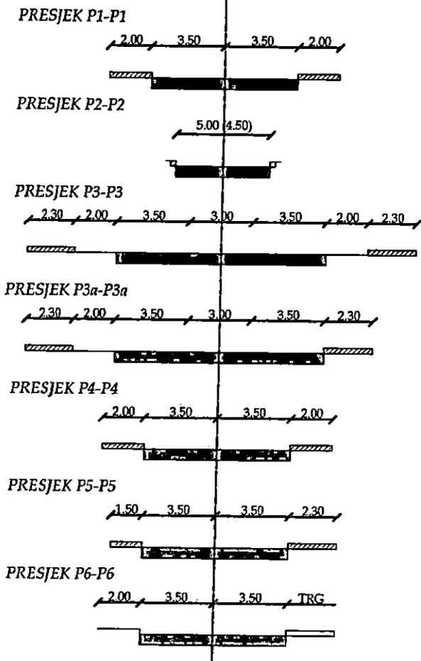
POPREČNI PRESJECI SEKUNDARNIH SAOBRAĆAJNICA :
