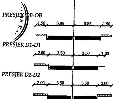
POPREČNI PRESJECI PRIMARNIH SAOBRAĆAJNICA :
