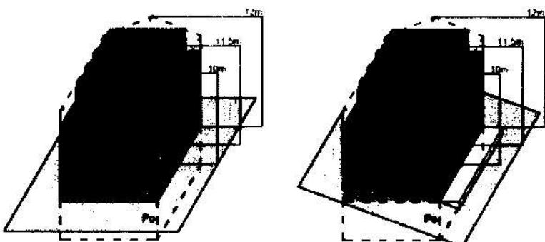
Najveća visina etaže za obračun visine građevine, mjerena između gornjih kota međuetažnih konstrukcija iznosi:
